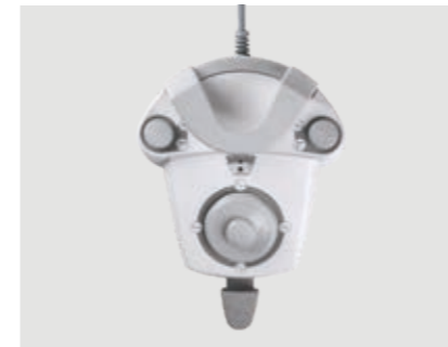
Mando de pie multifunción Dispositivo evolucionado con ergonomía de movilidad lateral que permite activar las funciones Chip Air y Chip Water en el instrumento utilizado, invertir el sentido de rotación del micromotor (después de haberlo extraído), desplazar el sillón y acceder a las posiciones de servicio. Disponible opcionalmente en versión wireless.
